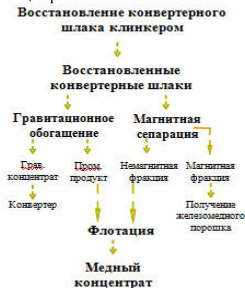
Рис. 1. Эффективная технология переработки конвертерных шлаков медного производства
