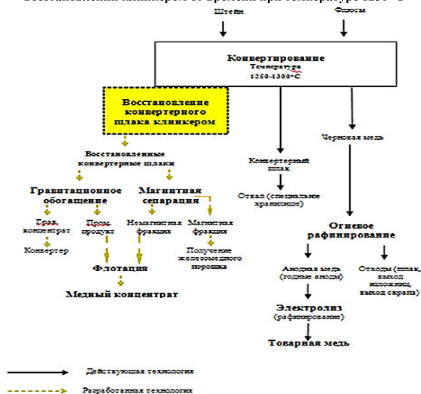
Рис. 4. Эффективная технология переработки конвертерных шлаков медного производства
