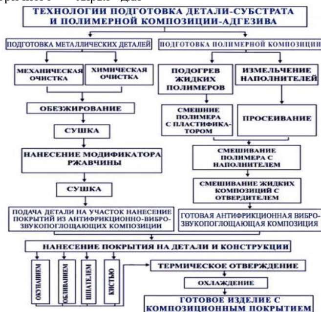
Рисунок 1. Технологические процессы получения антифрикционно-виброзвукопоглощающих композиционных полимерных материалов и покрытий на их основе
