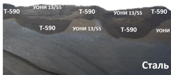
Рис.1. Схема расположения валиков при однослойном и двухслойном нанесении покрытия
