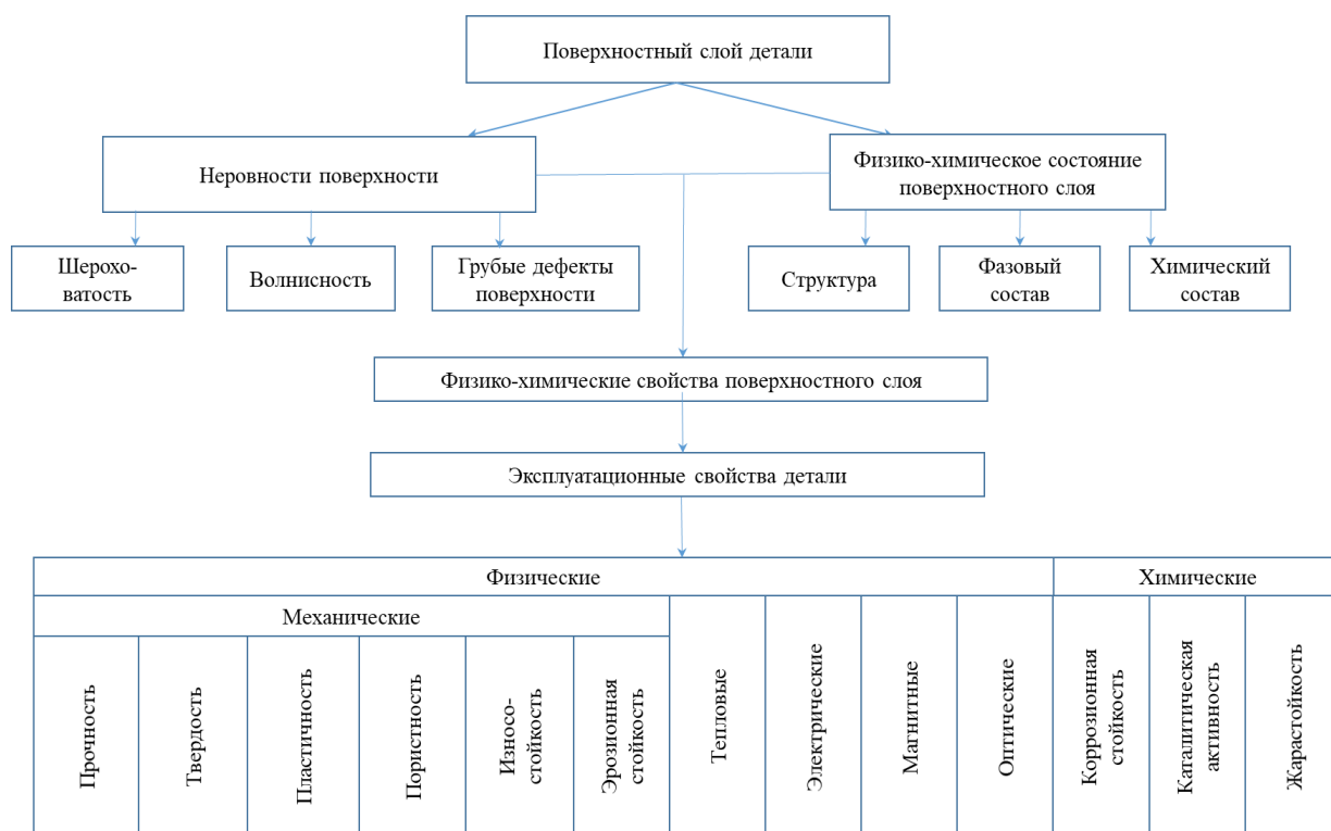
Рисунок 4. Взаимосвязь поверхностного слоя с эксплуатационными свойствами деталей
