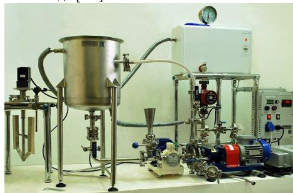
Расм. 1. Композит релс суртмасини тайёрлаш учун санат- лаборатория ускунаси
