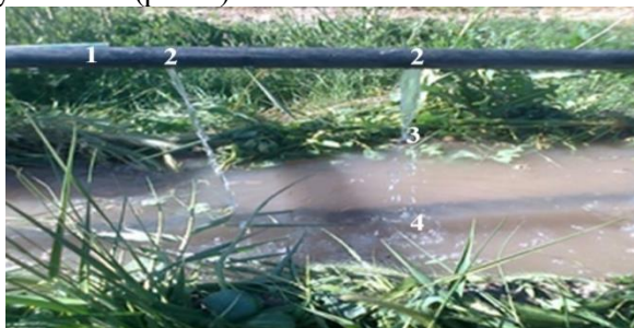
Рис.1. Общий вид экспериментальной установки. 1-труба для подачи потока недоочищенных стоков; 2-отверстия; 3- струи стоков; 4- приемная яма для стоков;
