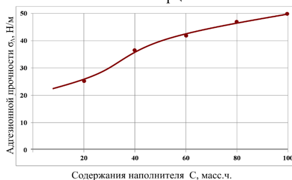
Рисунок 4 - Зависимость адгезионной прочности лакокрасочного эпоксифенольного покрытия в зависимости от содержания наполнителя - молотый кварц (среднее значение из 5 измерений в каждой точке)
