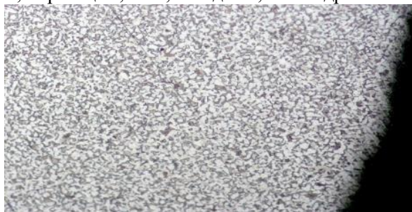
Микроструктура термоупрочненного арматурного проката в соответствии с ГОСТ 5639, ГОСТ 21014
