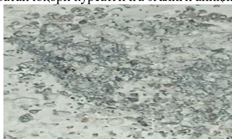
4-расм. Чиқиндининг микроскопик таҳлили (600 °С ҳароратда темир ва алюминийнинг тикланиши)
