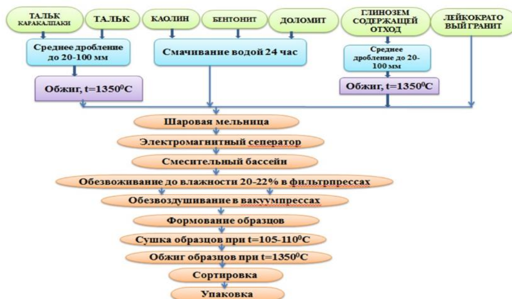
Рис. Технологическая схема получения композиционных глиноземистых электрокерамических материалов
