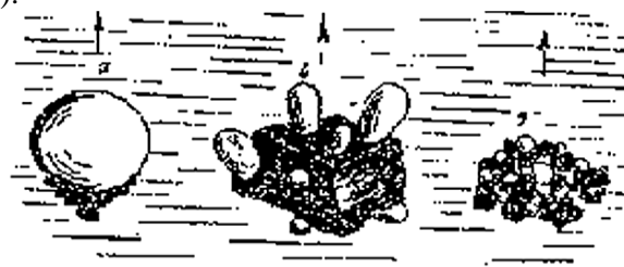
Рис. 2. Агрегаты минеральных частиц и пузырьков, образующихся в пульпе при флотации (В.И. Классен, 1959)
