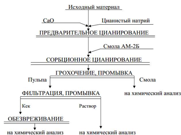
Рис.2. Схема экспериментов по сорбционному цианированию продуктов обогатения
