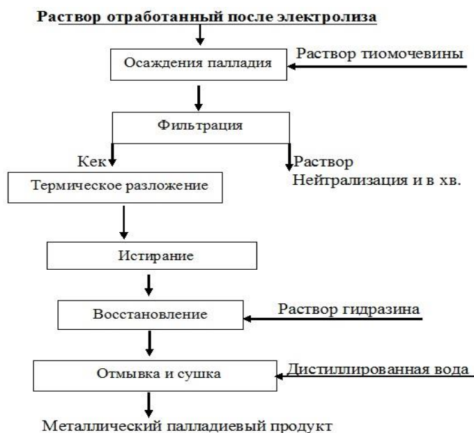
Рис. 2 Технологическая схема осаждения и восстановления палладия
