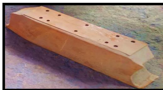
2-rasm “O‘zmetkombinat” AJ korxonasiida kulrang cho‘yanlardan olinayotgan yupqa devorli “ko‘tarma shiber”
