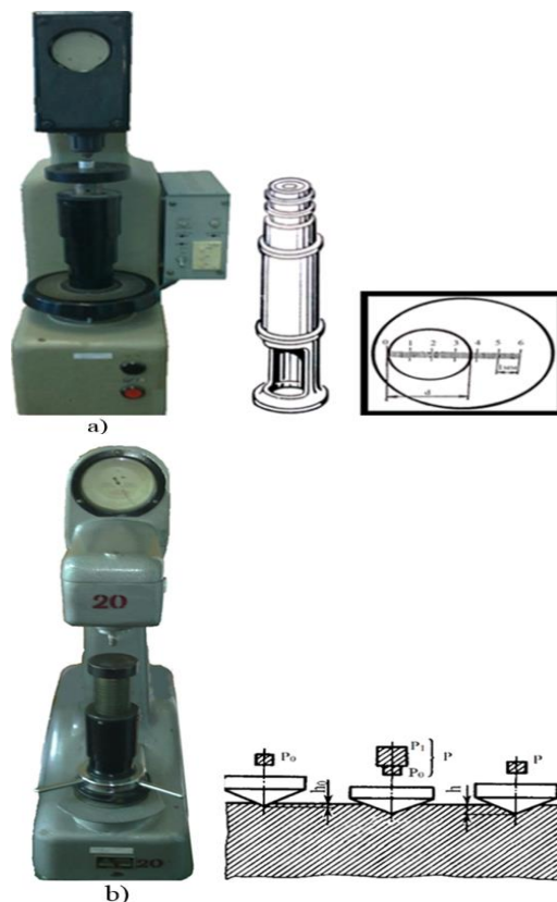
1-rasm. Yumshoq va toblangan qattiq po'latlarning qattiqligini o'lchovchi priborlar: a-Brinell; b-Rokvell ko'rinishlari
