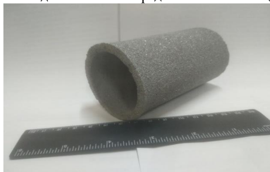
Рис.1 Фильтрующий элемент из коррозионностойкой стали марки ПХ18Н9Т полученным методом осаждения мелких частиц в пористую заготовку из газопылевого потока воздуха
