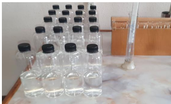
3-расм. Ареометрларнинг метрологик текширувларда қўлланиладиган метрологик хоссаларини тадқиқ қилишда фойдаланиладиган ишчи стандарт намуналар
