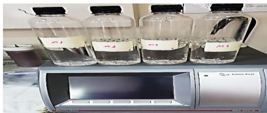
5-расм. Density Meter DMA 4500M типигади денситиметрнинг ташки кўриниши
