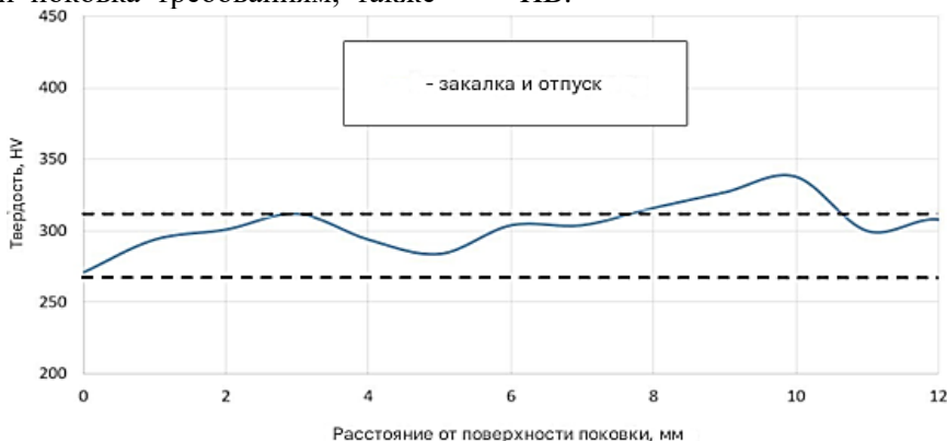
Рис. 8. Изменения твердости (НВ) в поперечном сечении в выбранной плоскости измерения для изделия, закаленного в масле и отпущенного
