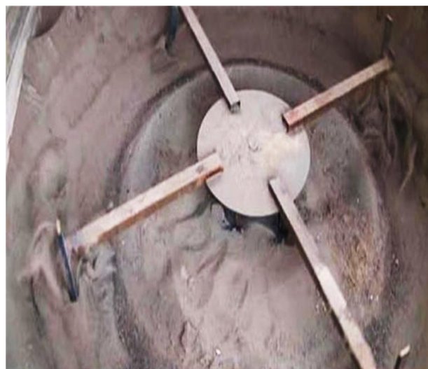
Рис.2. Лабораторная испытательная установка для определения объемного износа лап культиватора
