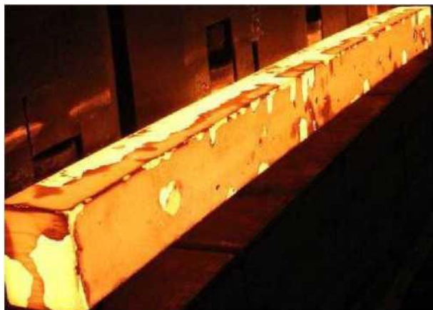
Рис. 2. Поверхность заготовки после гидросбива: а - с неудалившейся окалиной; б - участки расплавленной окалины
