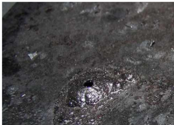
Рис. 2. Поверхность заготовки после гидросбива: а - с неудалившейся окалиной; б - участки расплавленной окалины
