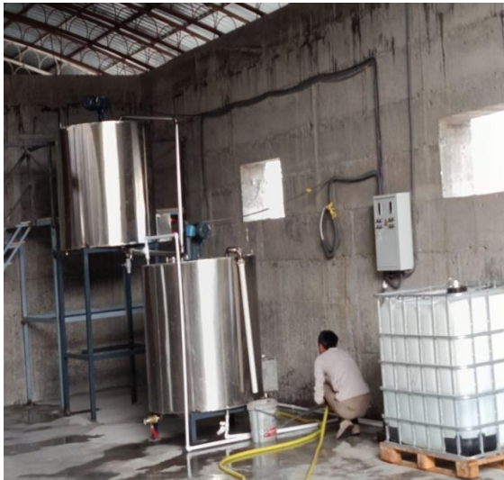
Рис. 3. Технологическая линия для производства демульгаторов в процессе испытания
