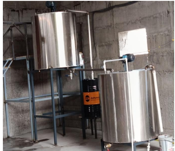
Рис. 3. Технологическая линия для производства демульгаторов в процессе испытания
