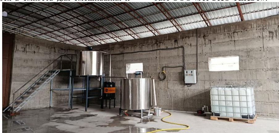
Рис. 2. Общий вид созданной технологической линии для производства композиционных химических реагентов-деэмульгаторов
