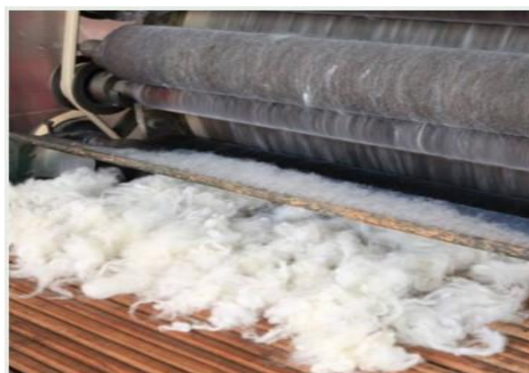
3-rasm. WJM-2 termal bog‘langan polyester va jun tolali to‘qilmagan matolarni (Termik usulda) ishlab chiqarish liniyasi geotekstil
