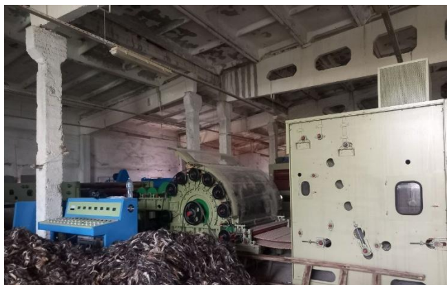
3-rasm. WJM-2 termal bog‘langan polyester va jun tolali to‘qilmagan matolarni (Termik usulda) ishlab chiqarish liniyasi geotekstil
