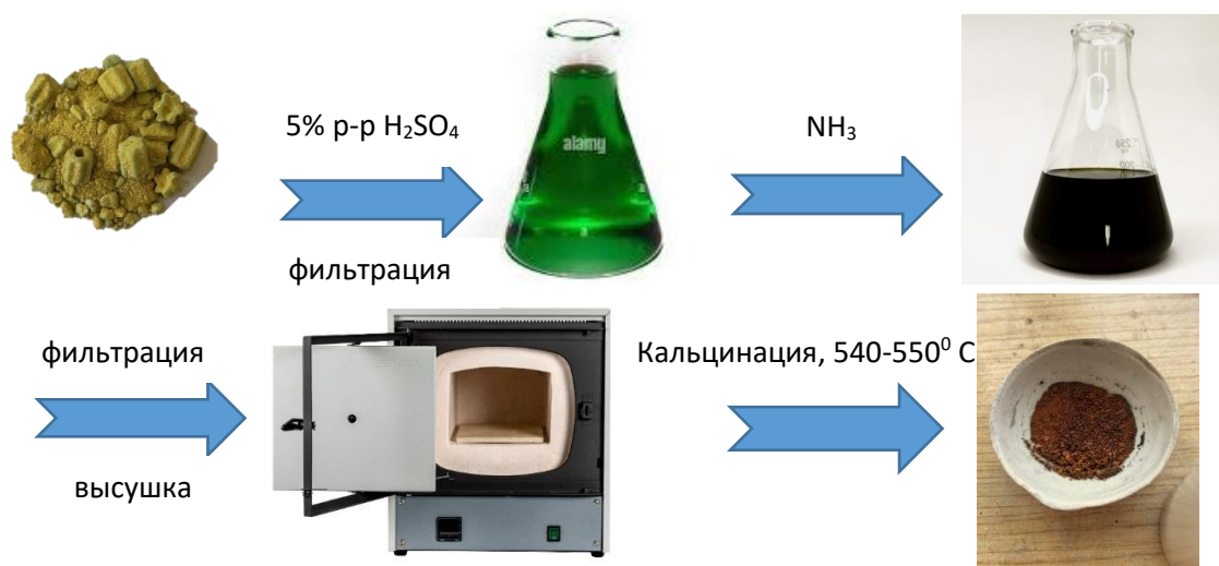
Рис. 2. Схема выделения оксида ванадия (V) из отработанного катализатора
