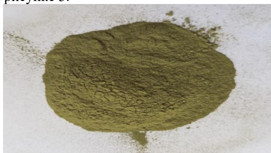
Рис. 3 Глауконитовый концентрат полученный методом отмучивания
