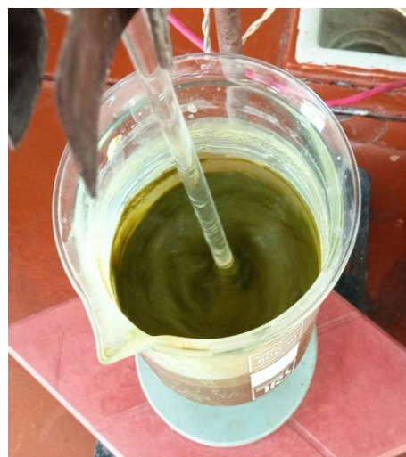
Рис.1. Затворение глауконитового порошка для отстаивания
