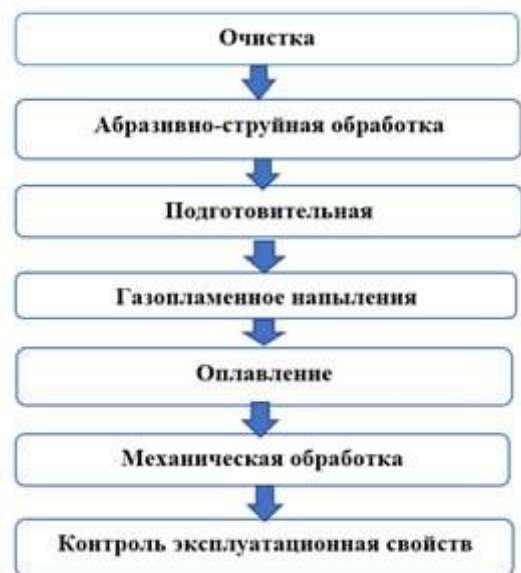
Рис. 3. Схема технологического процесса газопламенного напыления с последующим оплавлением
