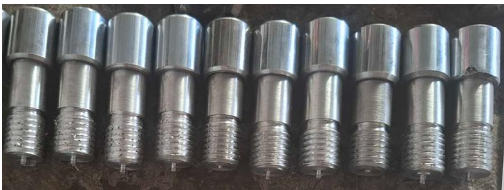
Рис.4. Лабораторные образцы для определения адгезионные свойства покрытий.
