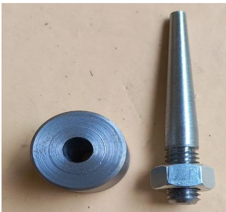
Рис. 2. Лабораторный образец изготовленный из материала Сталь 65Г
