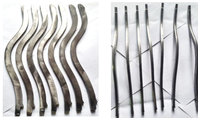
6-rasm. Zanglamaydigan po‘latdan tayyorlangan yangi linter kolosnikning tajriba nusxasi
