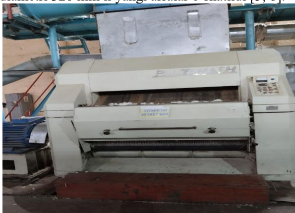
3-rasm. Takomillashtirilgan kolosnikli panjaraga ega bo'lgan 90 arrali jinni ishlab chiqarishdagi ko'rinishi
