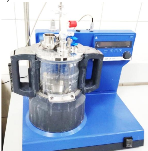
Rasm 2. Temir lomini (strujka, mix, yupqa devorli list) kislota yordamida eritish uchun IKA LR 1000 laboratoriya reaktori
