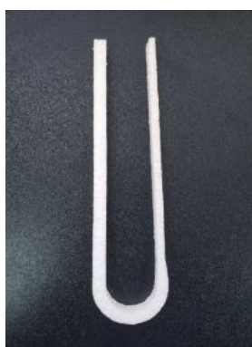
Рис.1. а) чертёжный вид U-образного образца. б) образцы U-образной формы, изготовленные из полипропилена
