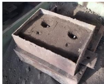
Рис. 2. Процесс размещения моделей из полипропилена в песчано-глинистую форму
