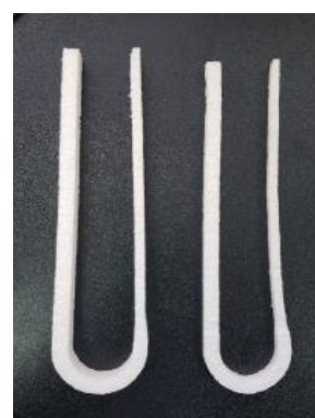
Рис.1. а) чертёжный вид U-образного образца. б) образцы U-образной формы, изготовленные из полипропилена
