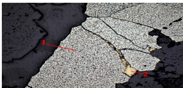
1-rasm. Pirit yoriqlari bo‘ylab xalkopirit tomirchasi. Kattalashtirish: \times 100 . 1 - pirit, 2 - xalkopirit
