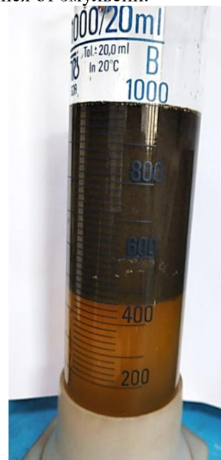
Рис. 1. Количество выделившейся воды из масла при её разрушении под воздействием, разработанного композиционного химического деэмульгатора «КХД-М-1»
