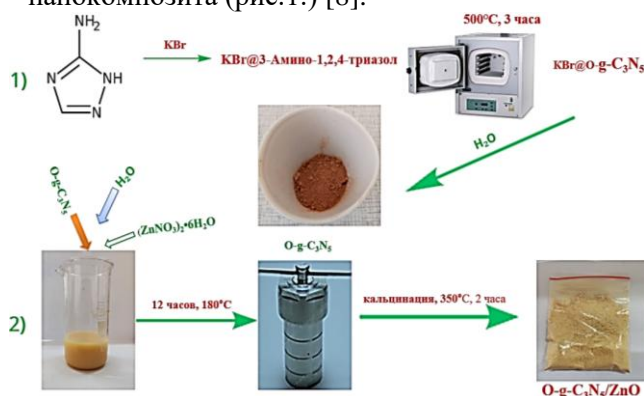
Рис.1. Схема синтеза нанокomпозита O-g-C_3N_5/ZnO
