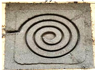
2-rasm. Suyuqoquvchanlikni aniqlovchi spiral qum-gilli qolip
