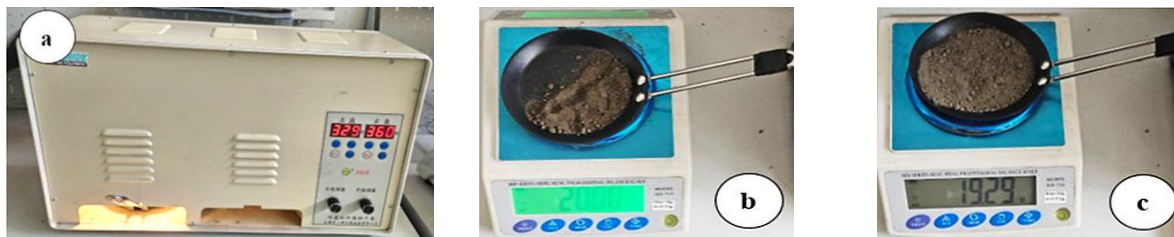
1-rasm. Qolip aralashmalari namlik miqdorini o'lchash.
