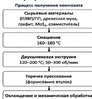
Рисунок 4. Экспериментальная установка и процесс получения образцов
