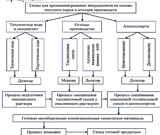
Рис. 1. Научно-методические и технологические принципы получения импортозамещающих композиционных химических ингибиторов для защиты от коррозии машин и механизмов, применяемых в процессе испытаний и оценке состояния нефтегазовой скважины
