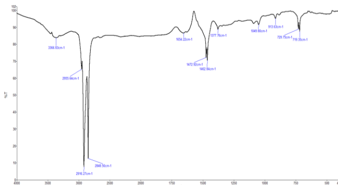
Rasm 2. Kulrang quyi molekular polietilenning (QMP) IQ spektri
